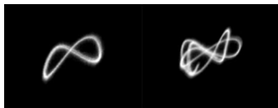
Lisažu kreivė osciloskopo, matuojančio besikeičiančias elektronines įtampas, ekrane.
